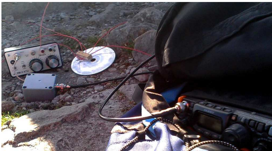
Radiales en el suelo, acoplador ZM-2 y Choque de coaxial montado en una caja estanca
